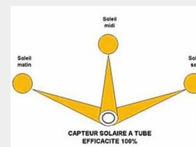
Même par faible rayonnement solaire et tout au long de la journée, le capteur à tubes sous vide offre des performances hors du commun. Le miroir réflecteur parabolique permet d'obtenir le même rendement quelque soit l'angle d'exposition..
