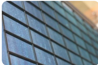
Echangeur de grande surface avec traitement hydrophile
