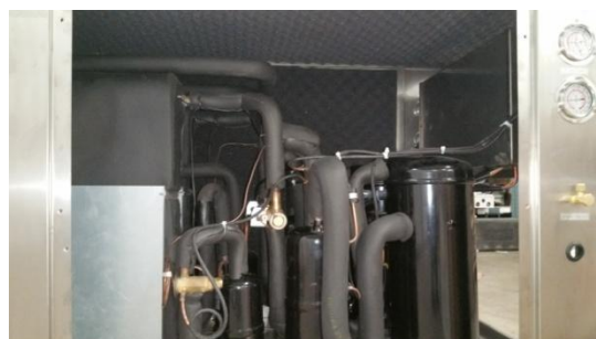
Isolation phonique totale de la tôle et tuyauteries
